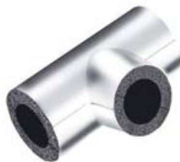
Тройники ST, SOLAR HT, ECO с покрытием AL CLAD предназначены для защиты предварительно заизолированных трубопроводов средних и больших диаметров. Внешний (основной) диаметр тройника предусматривает толщину теплоизоляционного слоя.
