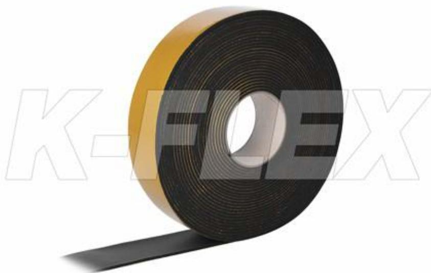
Самоклеящаяся лента из вспененного каучука K-FLEX ST, на одну сторону которой нанесен специальный клейкий слой, предназначена для герметизация клеевых швов и соединений из каучуковой теплоизоляции K-FLEX ST.
